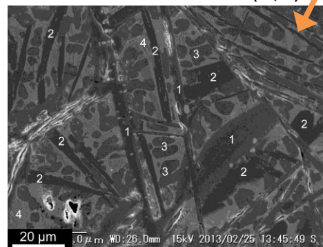
B 4 C/SUS/Zr/(U,Zr)O 2 の溶融固化物の例
