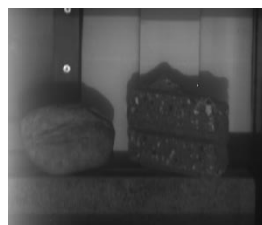
処理結果1:反射率画像 ・シート光掃引中の画像(数百枚)から作成 ・画素値はシート光反射率を反映 ・霧や水中でも鮮明な画像を取得可能
