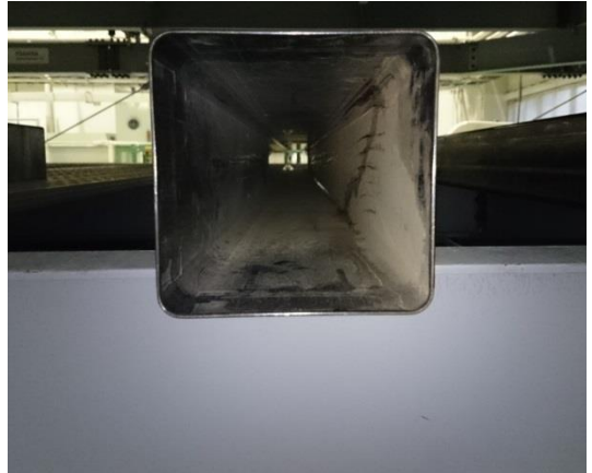
模擬燃料集合体 (容器内空洞) (T14, W421, H14)
