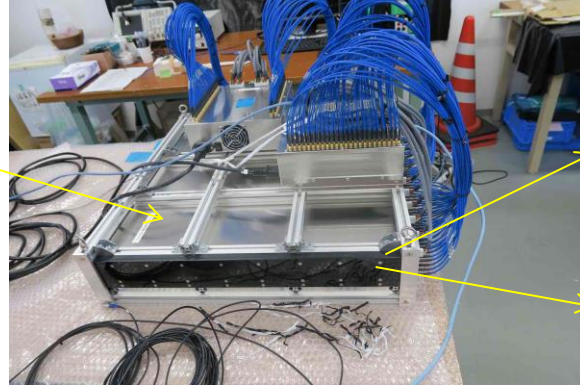
(b)X方向2層、y方向2層を重ねて組みあげたxx-yy検出器（検出器1ユニットの大きさは、54cm×54cm×12.3cm）
