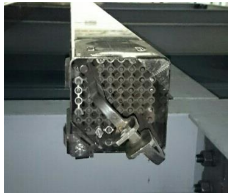
模擬燃料集合体 (容器内鉛充填) (T14, W421, H14)
