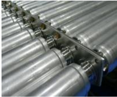
3.5mを2本接続し7m長化 (ユニット化)
