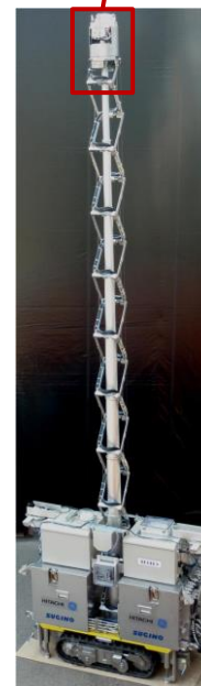
高圧水ジェット 除染装置
