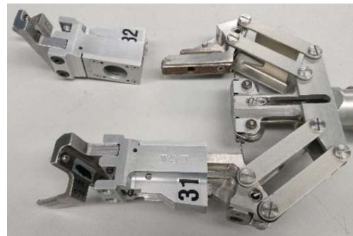
微細作業用フィンガを取り付けたDexterマニピュレータのハンド
