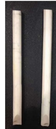
V字コアボーリングで得られた2本のアルミナの例
