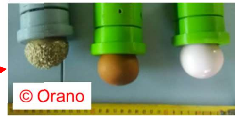
試作した吸着把持用グリッパ 左から「イボ付きシリコン」「ラテックス」「シリコン」
