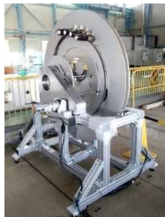
改良型中間屈曲機構と吊り下ろし装置(二重ケーブルドラム)
