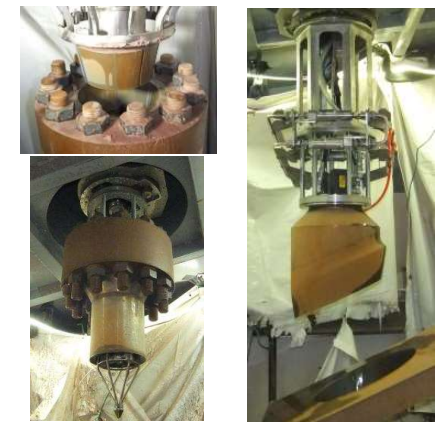
RPVヘッド予備ノズル撤去試験(2017年度)
