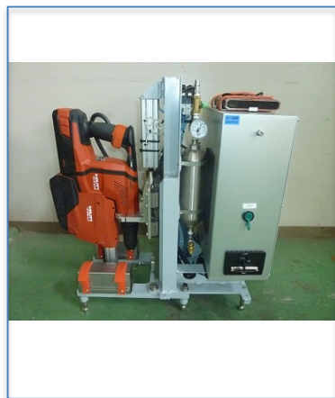
図1 遠隔試料採取装置 試作機(単体)
