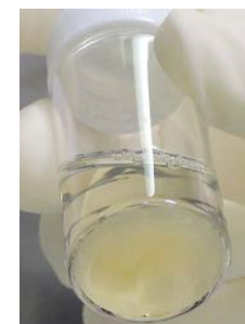
図2 酸化セリウム吸着材の不溶解残渣
