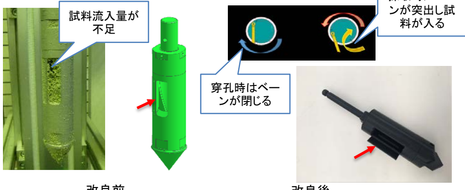
図2 改良前後のサンプリングヘッド
