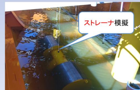
工場試験（ストレーナ埋設前）
