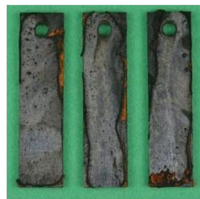
全面腐食発生あり 防錆剤添加なし
