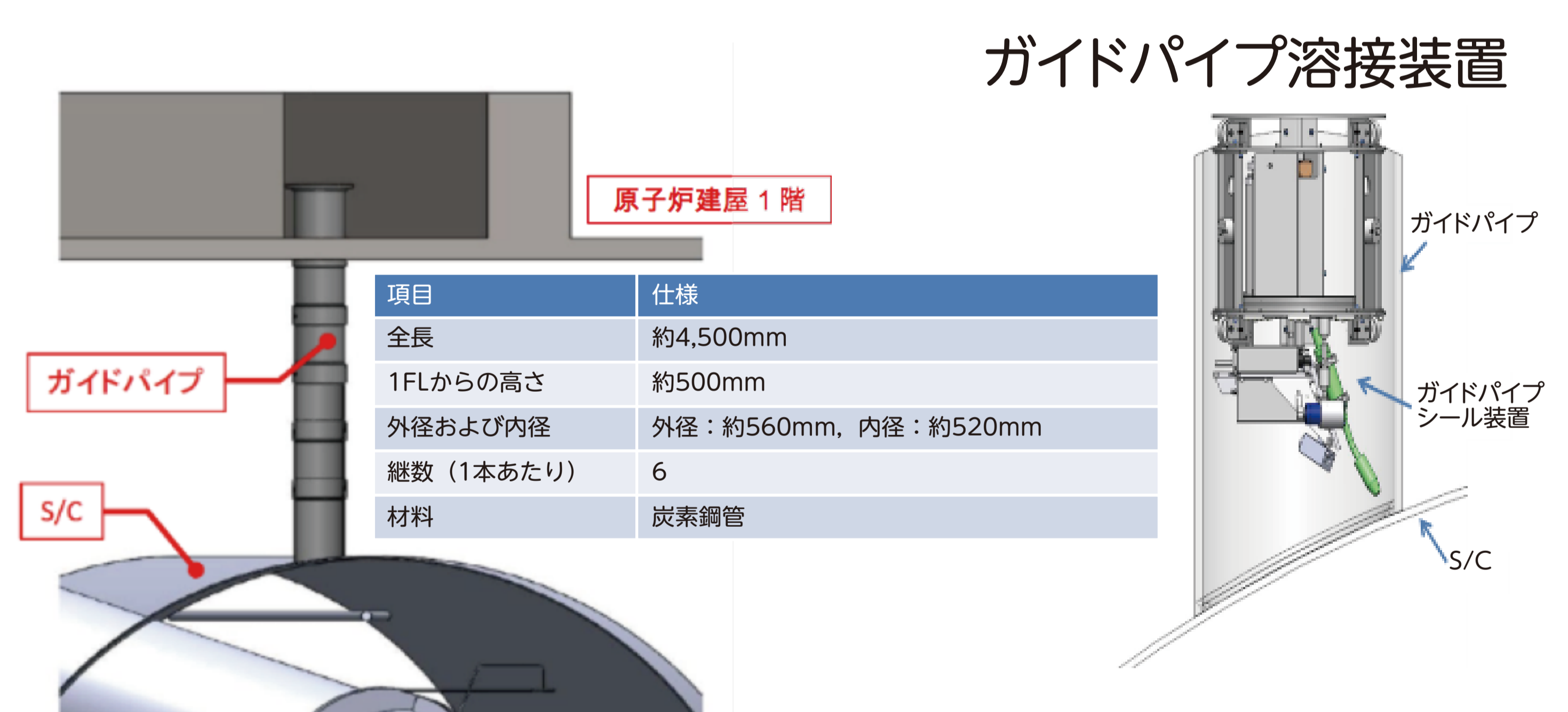
S/Cガイドパイプ施工の例
