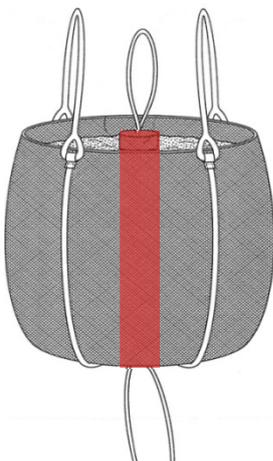
自重脱水の仕組み
