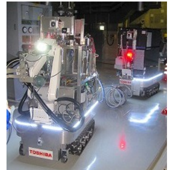
ドライアイスブラスト除染装置
