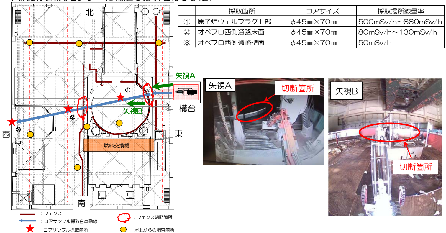
図6 フェンス切断箇所及びコアサンプル採取箇所
