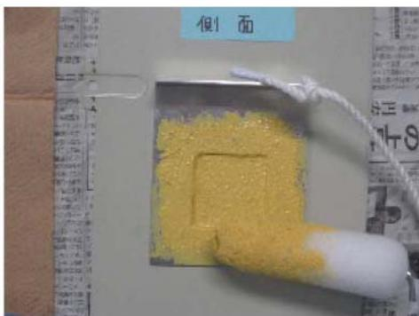
図12 ストリップابلペイント採取作業
