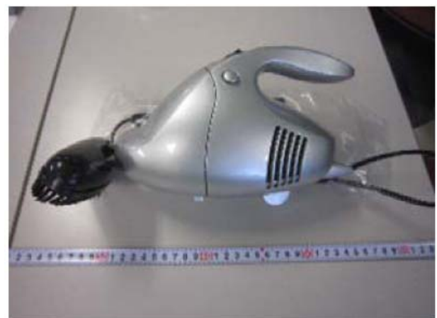
図13 小型吸引回収装置
