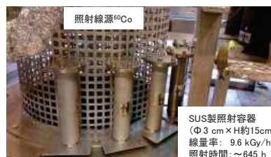
γ線照射試験の様子 (HCNの生成に関し 6 MGyを照射)
