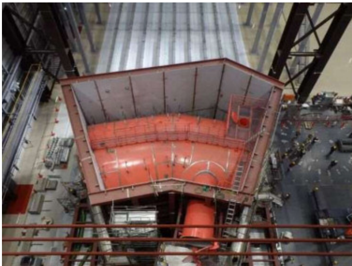
写真3 試験体本体 建込み状況
