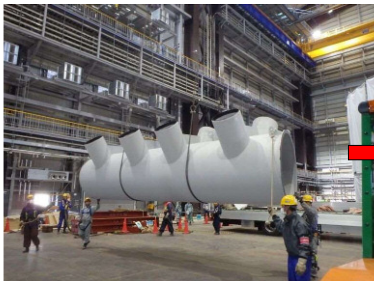
写真2 ベントヘッド・ダウンカマの組立
