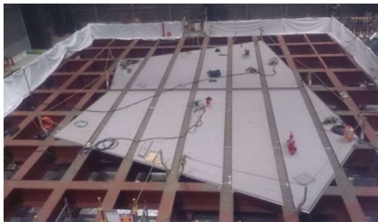
写真1 試験体用架台の組立・溶接
