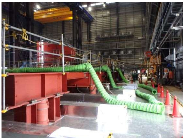
写真1 試験体用架台の組立・溶接
