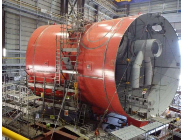
写真 1 S/C シェルの接合
