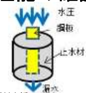
鋼材を挿入したNWGの透水試験の概要
