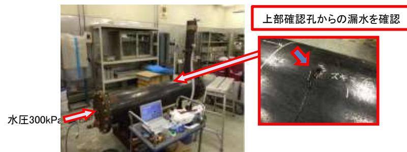
加圧試験装置と加圧により漏水が認められた上部確認孔
