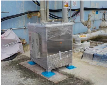
小型ミュオン測定装置※1（2号機の設置実績） （約1m×1m×高さ1.3m）
