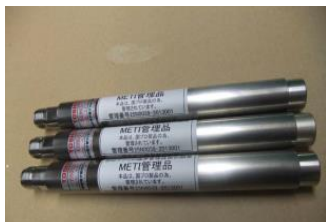
臨界近接監視システムの B-10中性子検出器
