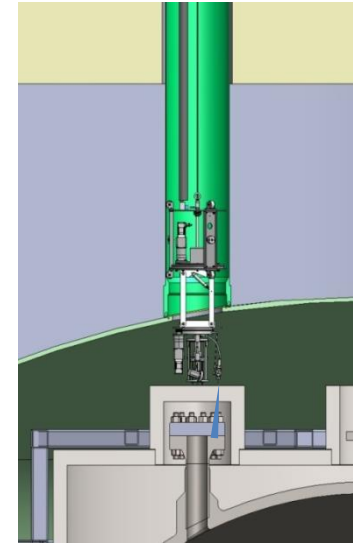
RPV保温材開口作業
