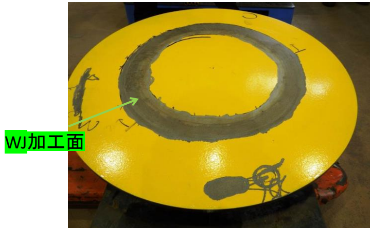
PCVヘッド模擬体 WJによる塗装等剥離後の表面状態
