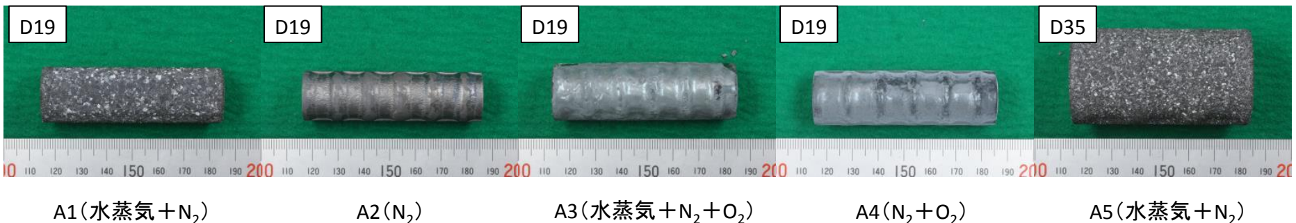
曝露後の鉄筋の外観
