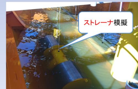
工場試験(ストレーナ埋設前)
