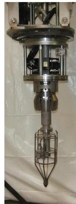
フランジ内側切断装置
