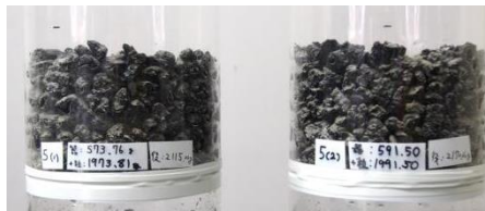
粒状溶岩に付着した中性子吸収材の重量測定結果
