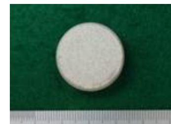
水ガラス/Gd 2 O 3 造粒粉材 (硬化後)
