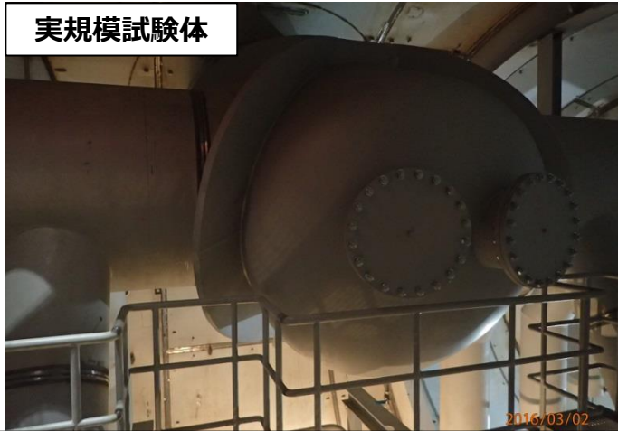
施工対象 (S/C、ベント管、干渉配管) を1/1で模擬
