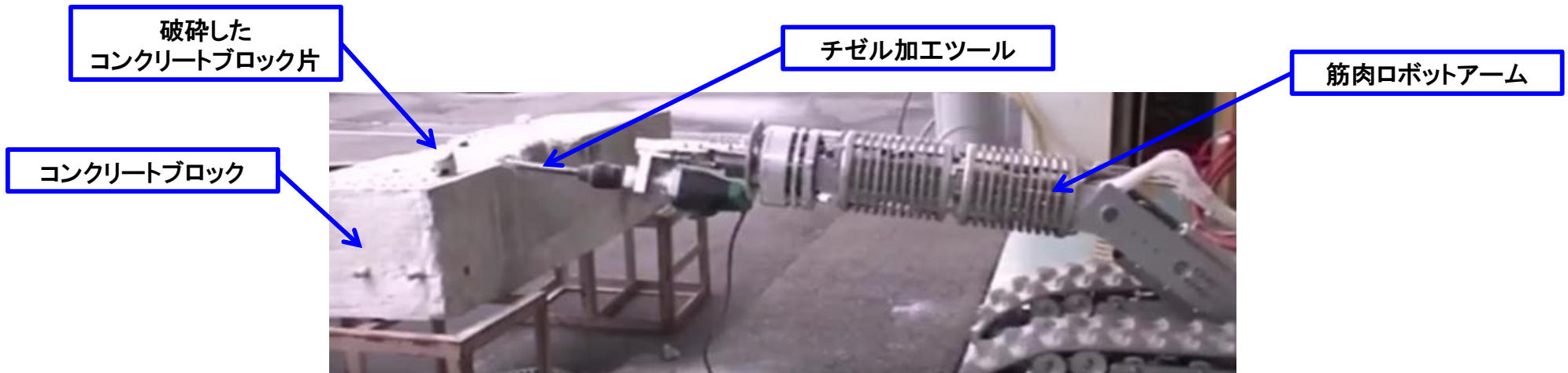
チゼル加工によるコンクリートブロック破砕状況
