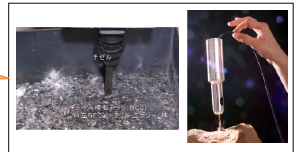
燃料デブリの拡散防止の観点で有効な加工方法
