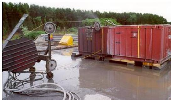
固化済みコンテナの切断
