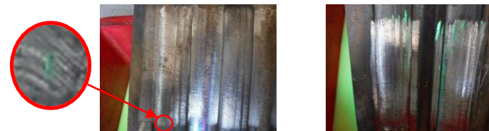
磨き残しによる疑似欠陥の例
