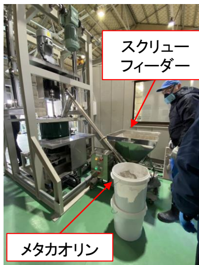
混錬装置(メタカオリン投入)
