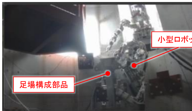
小型ロボットが足場構成部品側面に掴まる作業
