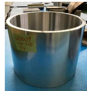
ジェットポンプ ライザ管
