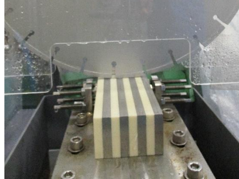
ディスクカッタ(干渉物撤去)被削材サイズアップ加工試験
