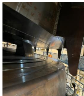
可動フランジ動作時のガイド状況
