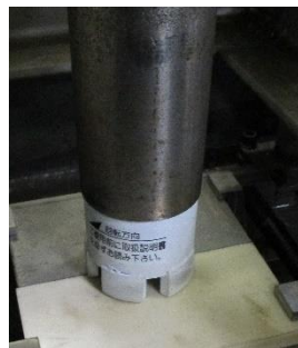
コアボーリング切粉排出性確認試験(10kN、250rpm)
