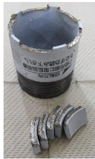
コアボーリング切粉排出性確認試験(10kN、250rpm)
