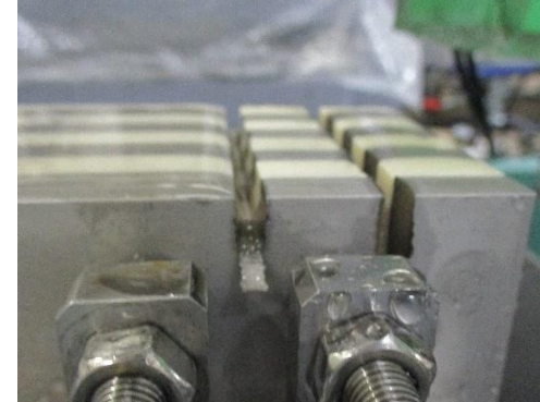
ディスクカッタ(干渉物撤去)被削材サイズアップ加工試験
