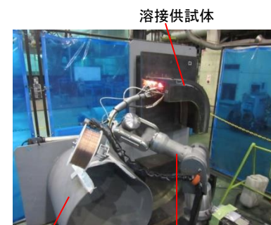
溶接供試体 模擬X-6ペネ マニピュレータ (IRID所有品)
