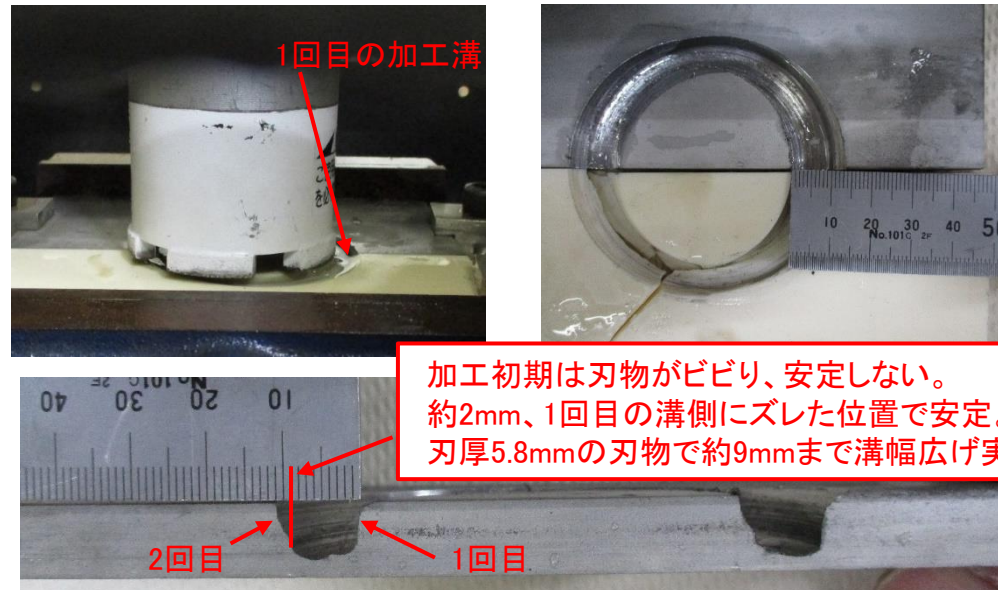
コア切断用ディスクカッタ挿入穴加工試験(10kN、250rpm)
