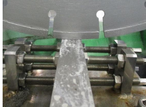
ディスクカッタ(干渉物撤去)SUS単体加工試験
