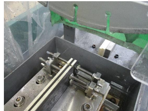
ディスクカッタ(干渉物撤去)加工速度確認試験
