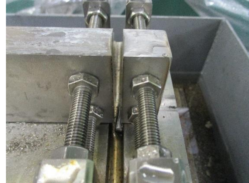
ディスクカッタ(干渉物撤去)SUS単体加工試験
