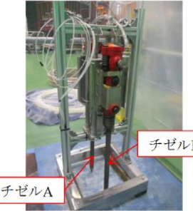
双腕電動アームによる塊状燃料デブリ加工
