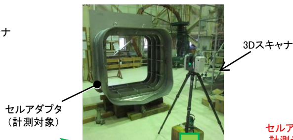
セルアダプタのPCV接続面の3D計測
