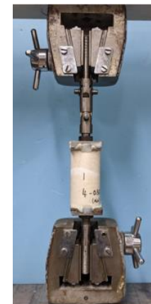
直接引張試験写真
