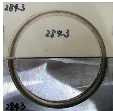
コアボーリング 加工速度確認試験
