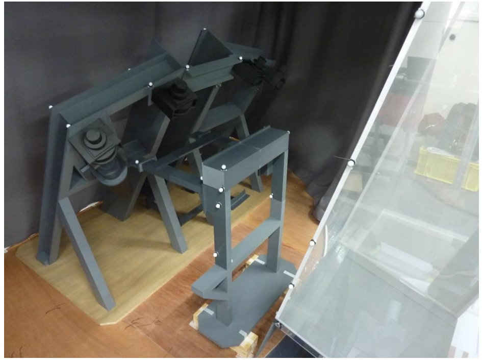
ペDESTAL内の損傷構造物モックアップ (傾いたプラットフォームフレームが開口部付近に存在)
