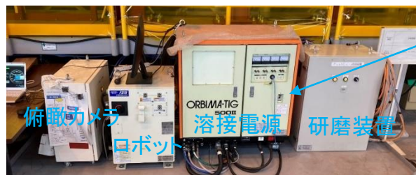
制御装置(ロボット、研磨装置、俯瞰カメラ)&溶接電源
