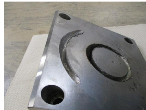
コアボーリング30° 傾斜部加工試験
