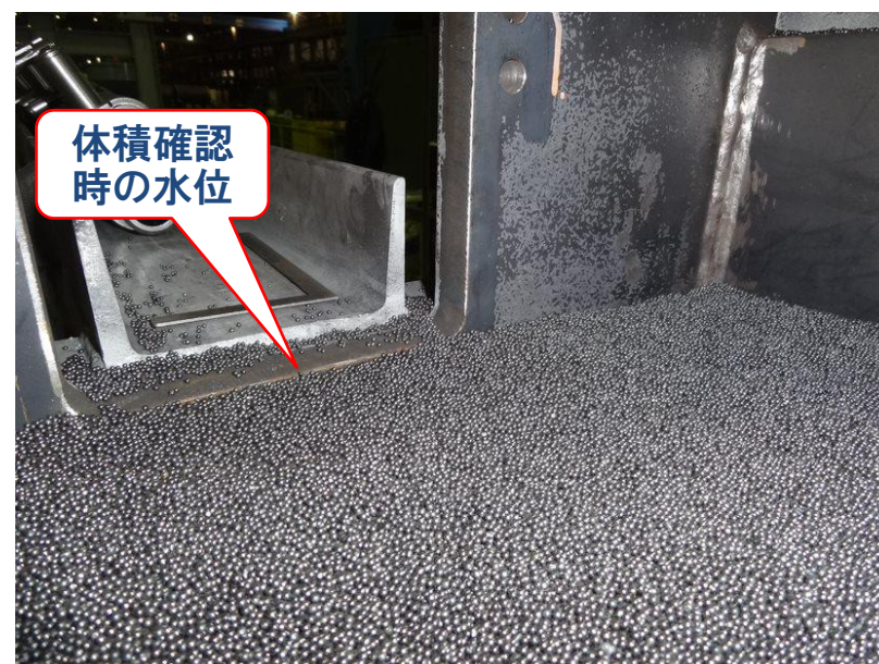
充填状況(天井セル/500mm幅)
