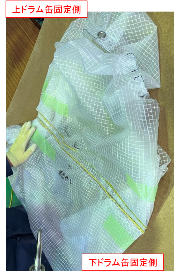
溶着後の状態(切断前)
