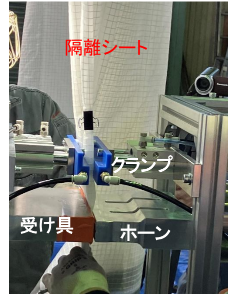
③ 隔離シート溶着準備 (紙面手前側にシート移動、クランプ)
