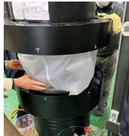
③上部ドラム缶へ収納ボックス設置
