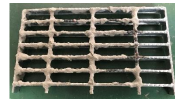
No.6 加工後のデブリ片 (フェーズドアレイで測定が困難な形状)
