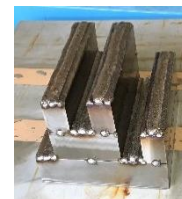
No.6 加工後のデブリ片 (フェーズドアレイで測定が困難な形状)
