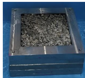
No.5 チゼル加工後 (破碎模擬試験体)
