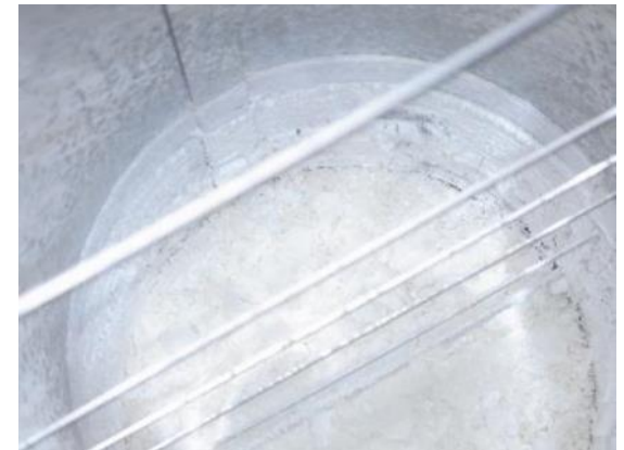
図 凝集剤フロックスラリー・スラッジ乾燥後(充填高さ200mm, 乾燥時間20.5h)
