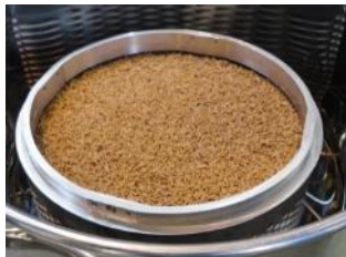
図 乾燥試験対象(UC充填ゼオライト)
