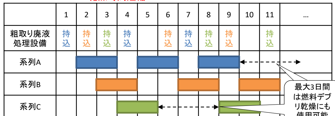
図 粗取り廃液処理由来のスラリー・スラッジの持込頻度と乾燥処理時間(300°C乾燥)
