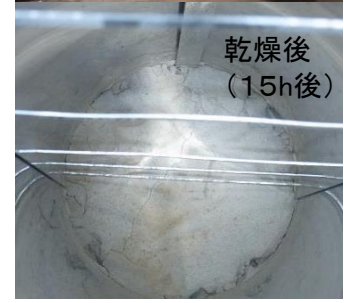
(3)スラッジ状況(スラッジ初期高さ200mm)
