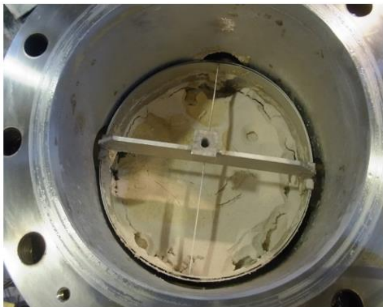
図1 珪砂 100\mu\text{m} 、高さ785mm乾燥後
