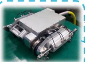
VT-ROV ベント管付根部調査用
