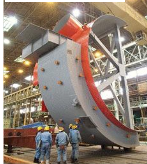
S/Cシェルおよび水槽組立状態
