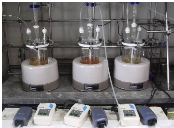
腐食試験状況と結果の一例（炭素鋼・低合金鋼）
