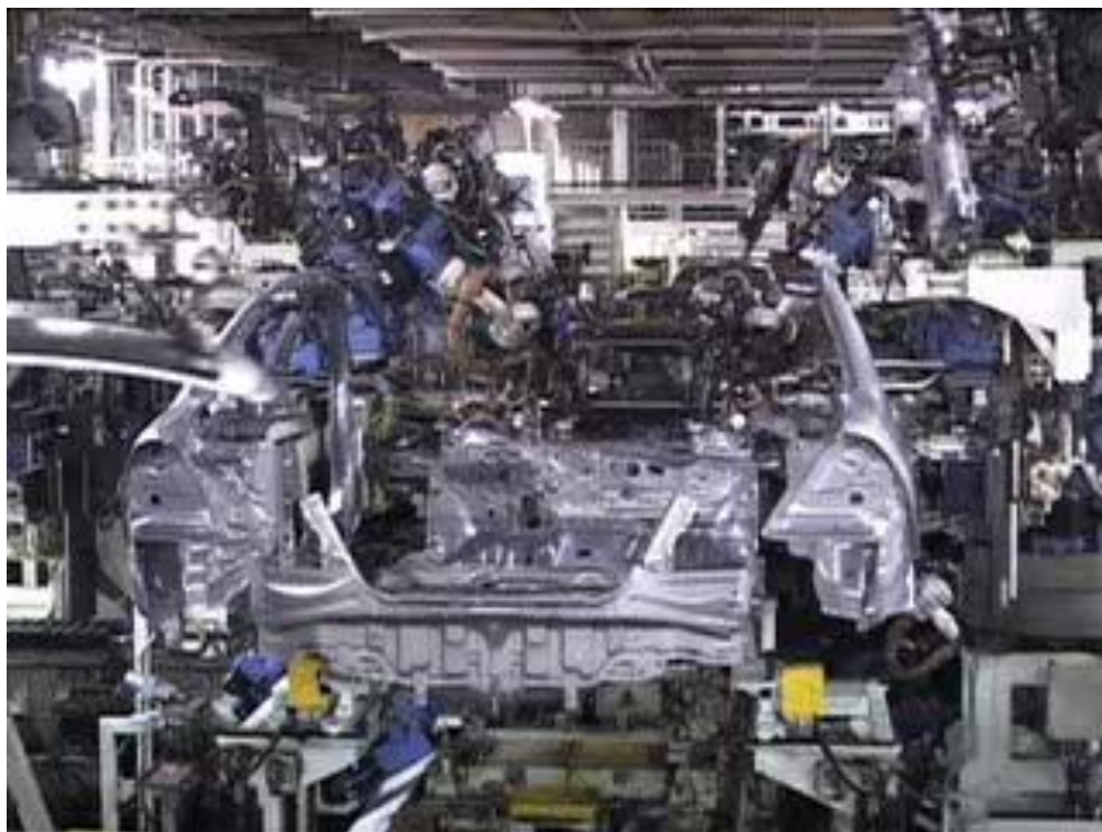
自動車製造：溶接工程
