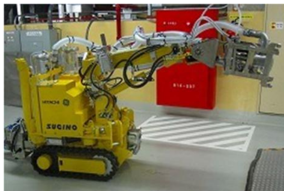
高圧水除染装置
