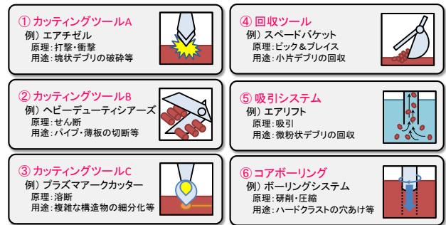
図5 TMI-2 で用いられた燃料デブリ取出し装置の分類
