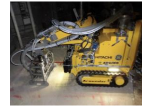
高圧水ジェット除染装置
