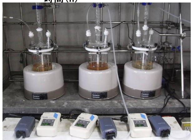
腐食試験状況(例)
