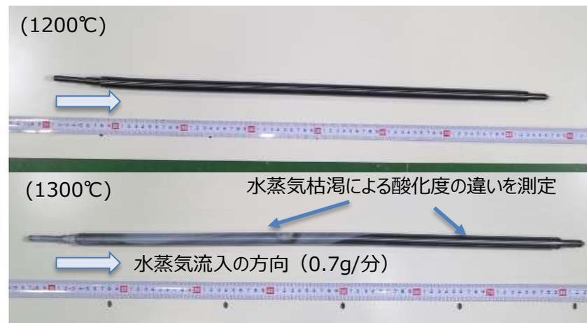
水蒸気枯渇条件でのジルカロイ管酸化試験の例
