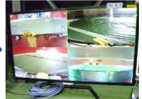
空気と水の置換および カメラによる完了確認
