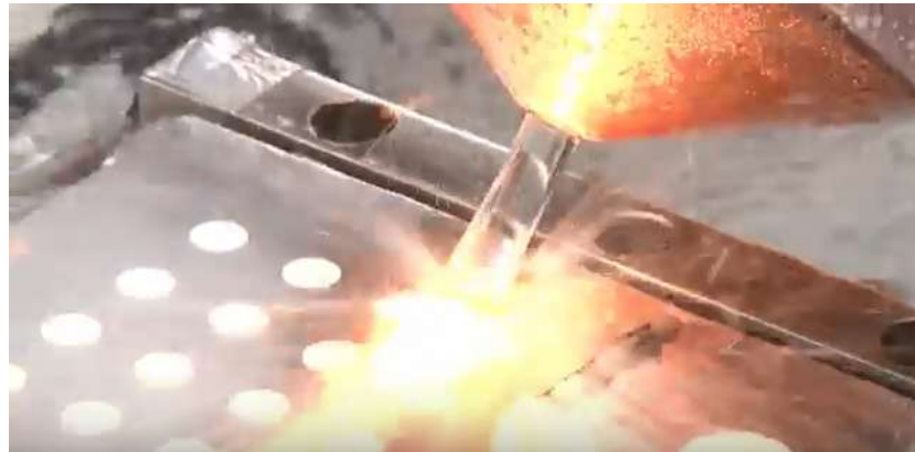
レーザガウジング加工状況
