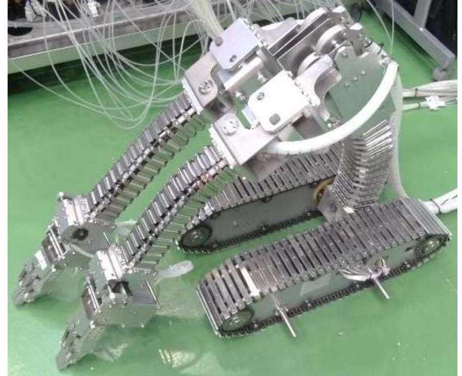
試作機 タイプⅤ 寸法: 全長1710mm 幅370mm 高さ185mm(胴部) 重量: 約70kg
