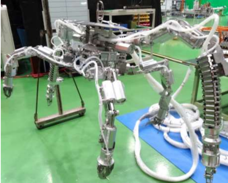
試作機 タイプⅣ 寸法: 全長2000mm 幅2800mm 高さ325mm(胴部) 重量: 約70kg
