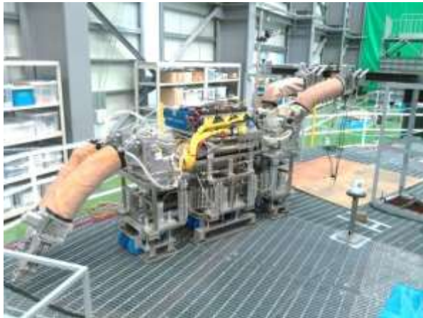
試作機 タイプ I 寸法:全長4350mm 幅630mm 高さ1000mm 重量:約700kg
