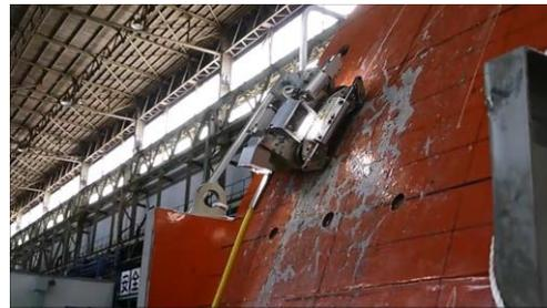
S/C内水位をS/C外面より超音波で測定する
