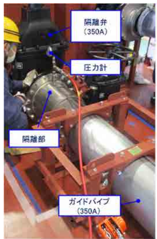
図4.2.1-4 (a) リークテスト (写真は350A)
