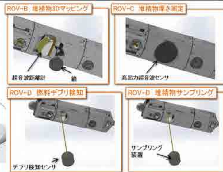
図4.1.1-7 ROV-B～E(計測・サンプリング用)
