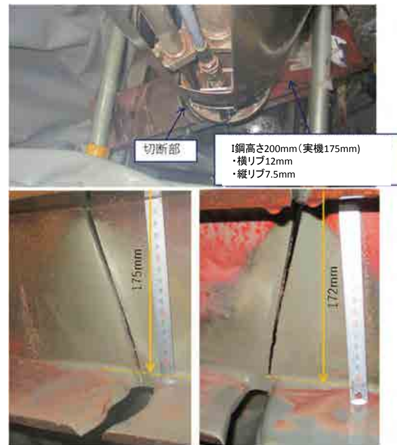
図4.2.1-3(l) 切断能力確認結果
