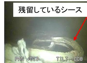
シースが残留している部分もあるが、PCV内の雨にさらされている部分は残留物がなため、ケーブル模擬はシースを全て取り除く。
