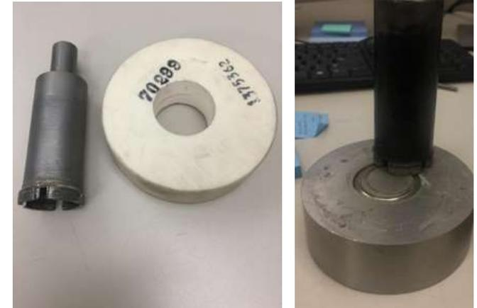
ダイヤモンドコートされたビットで切削されたセラミック(アルミナ)(左)と金属(ステンレス)(右)。
