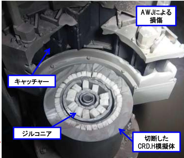
回収ツールの損傷防止のため、AWJが当たる位置に超硬のキャッチャーを設置していたが、激しく損傷
