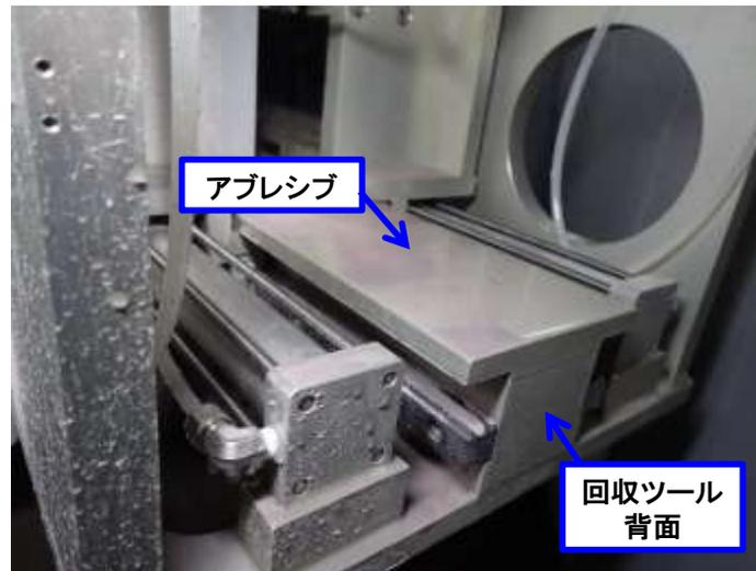
回収ツール駆動部への堆積
