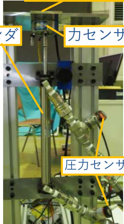
1軸油圧シリンダ試験機
