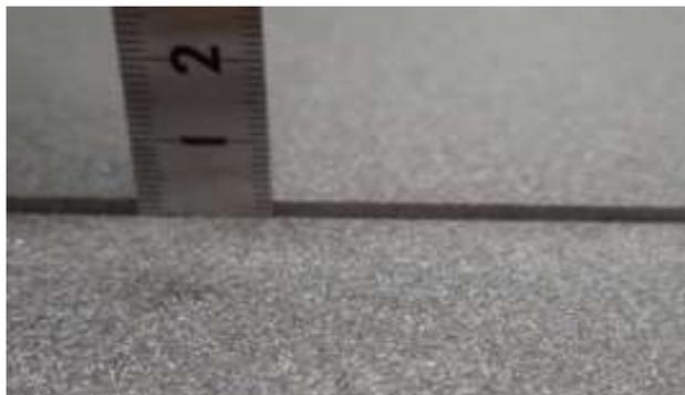
(d) BSW型枠継ぎ目中央段差(2mm)
