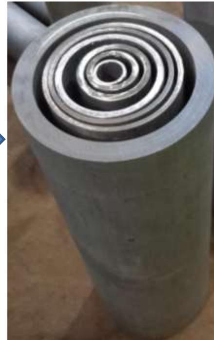
SUS製8重管試験体
