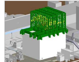
1号機プール燃料取り出し用架構イメージ
