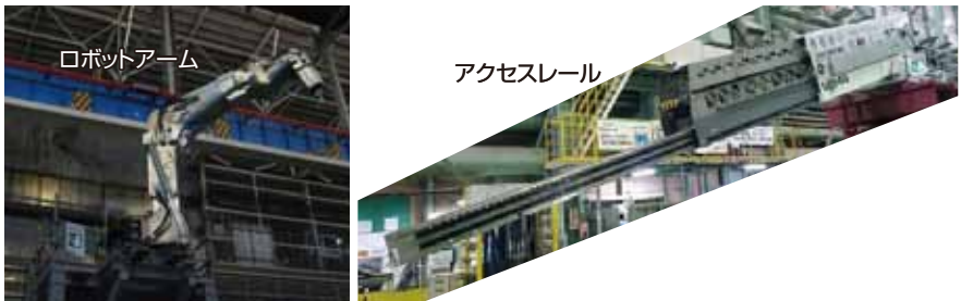
図5 ベDESTAL内アクセス装置の試験
