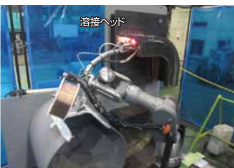
図8 PCV溶接装置の試験
