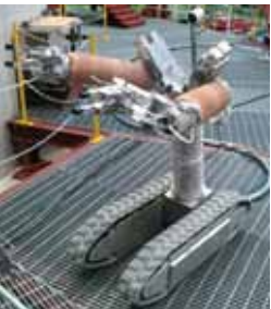
図6 遠隔作業用柔構造アームの試作例
