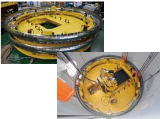
図2 RPV内アクセス装置(炉内装置)実機大モデル
