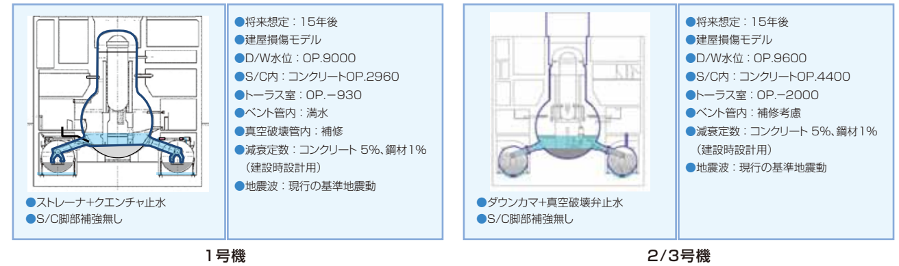
図2 S/C脚部の耐震性評価条件例
