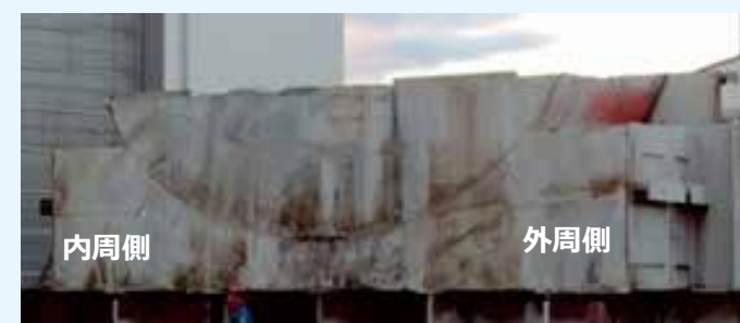
図9 ワイヤソーによる実規模試験体の切断面
