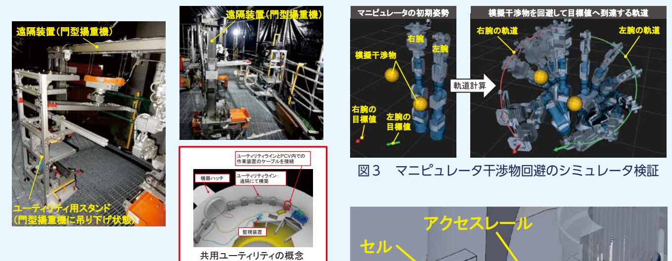
図2 ペDESTAL外周部へのユーティリティ構築に関する要素試験
