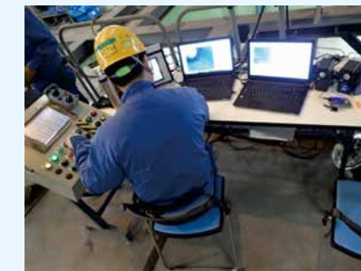
図2 延長配管-S/C継手溶接装置 遠隔作業状況
