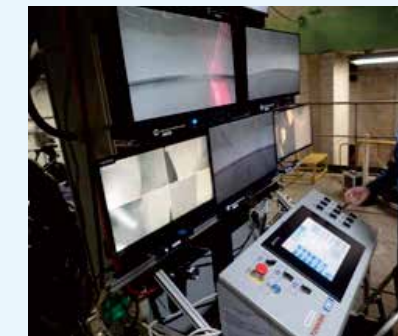
図3 位置合せ装置遠隔作業状況
