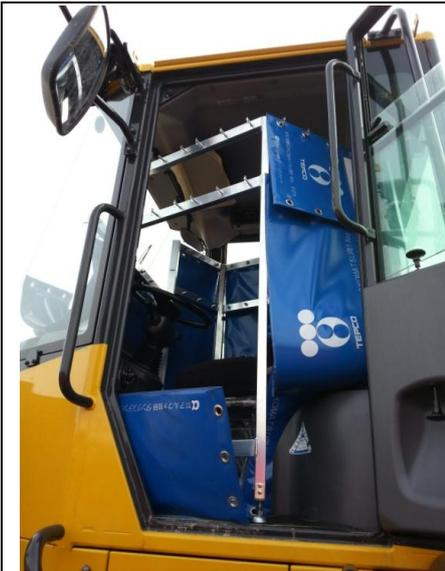
写真-3. Dfシートにより重機の運転室の左側面を遮蔽した状態を示す写真
