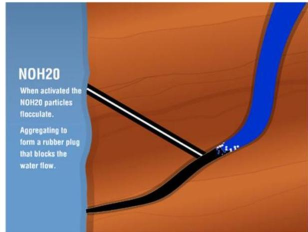
図-3② NOH2O の凝集、積層による止水
